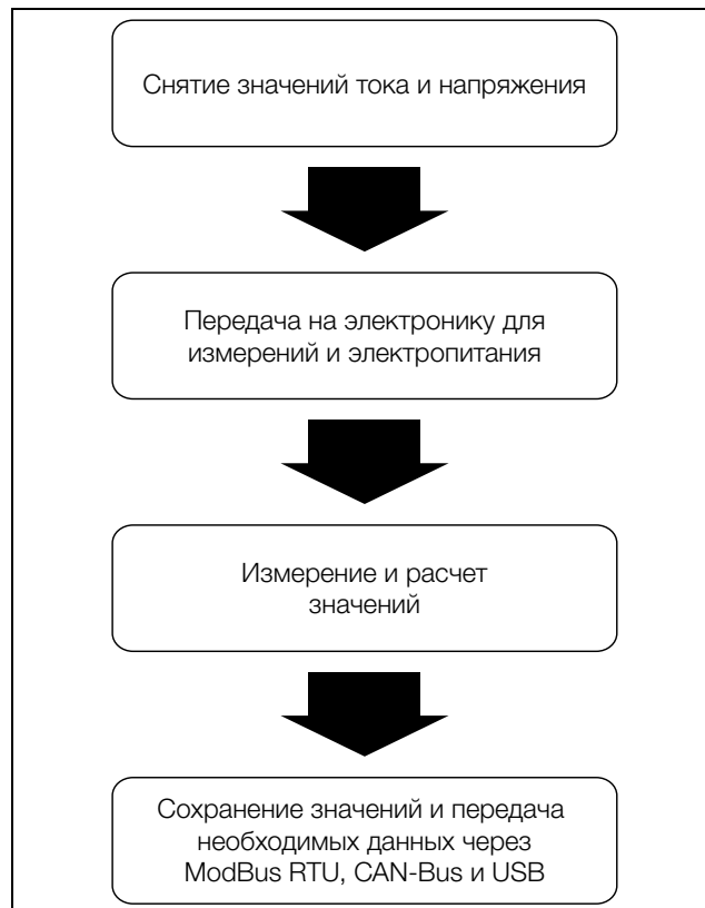
Рис. 1: Функциональное описание измерительного модуля NH
